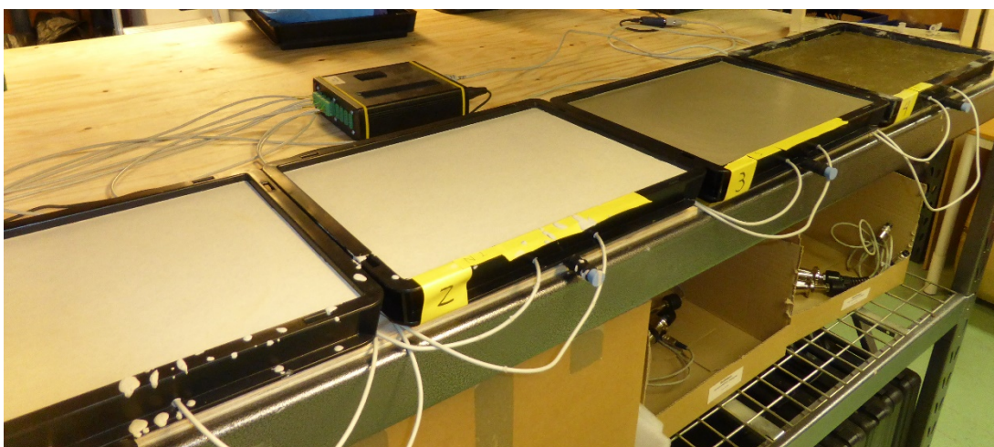
Bild 14: Förtillverkade "testgivare" ingjutna i olika typer av avjämnningar för loggning av indikeringsvärden.
