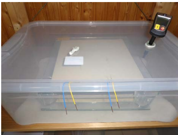
Bild 9: Klimatisering av 3 mm avjämningskikt med ingjutna koppartrådar i 43% resp 75% RF med salter, avläsning manuellt.
