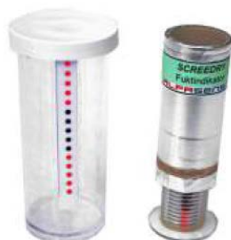
Bild 3: Ingjuten fuktsensor: Weber Floor Screedry
