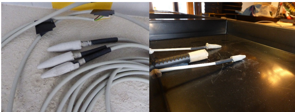
Bild 12 och 13: Tillverkade "testgivare" av koppartråd i avjämningskropp tv. Förberedda inför ingjutning i back th.
